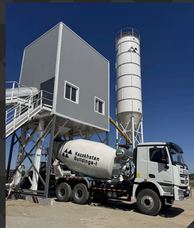
БЕТОННЫЙ ЗАВОД И АВТОБЕТОНОСМЕСИТЕЛЬ XCMG · 10 м³
